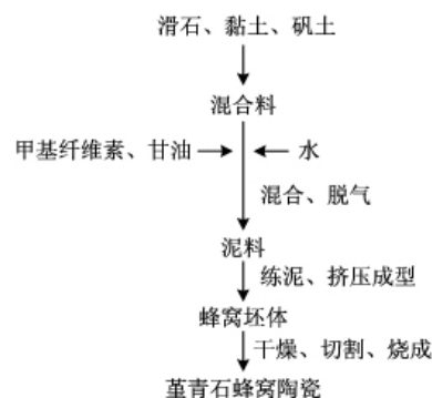
图2 堇青石蜂窝陶瓷的生料生产工艺
