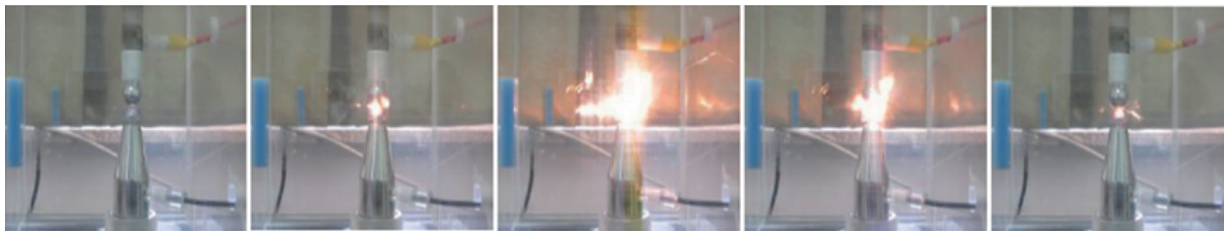
图 3 GTM 的静电火花点燃过程
