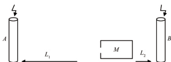
图 3 钢筋导体中暂态过电流对回路的影响 Fig. 3 Effect of transient over-current on circuit
