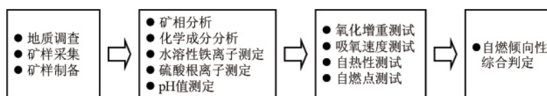
图 6 硫化矿石自燃倾向性综合测试流程
