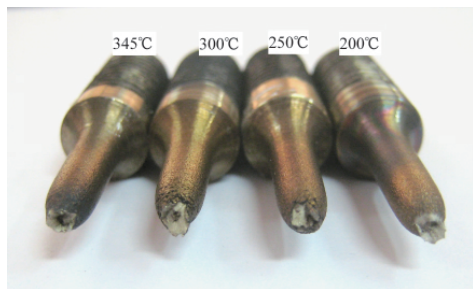
图3 304L 不锈钢试样断口宏观形貌
