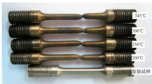
图 2 304L 不锈钢试样在试验前后的宏观形貌
