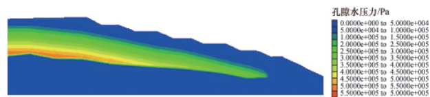
图 2 孔隙水压力等值线图
