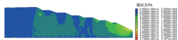
图 3 剪应力等值线图
