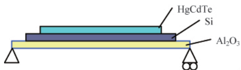
图 1 计算热应力的焦平面器件模型 Fig. 1 Finite element model of focal plane assembly
