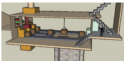
图7 地下垃圾压缩站平面示意
