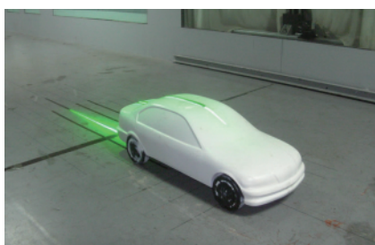
图 5 模型风洞试验 Fig. 5 Model tunnel test
