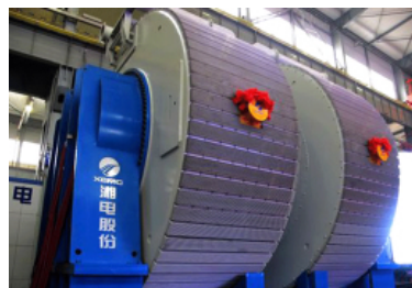
图 16 世界首台 5MW 永磁直驱海上风力发电机 (图片来源:中国风电材料设备网)
