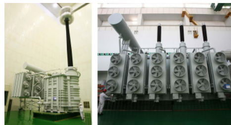
图 10 BKD-320Mvar/1100kV 特高压并联电抗器 (左) 和 SFP-820MVA/220kV 特大容量三相双绕组无励磁调压变压器 (右) (图片来源:特变电工衡阳变压器有限公司)
