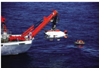
图 15 中国首台自行设计、自主集成研制的“蛟龙”号 深海载人潜水器 (图片来源:中国大洋协会)
