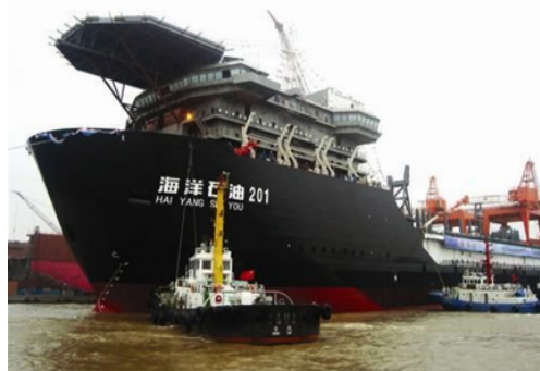
图 13 3000m 深水铺管起重船“海洋石油 201” (图片来源:人民网)
