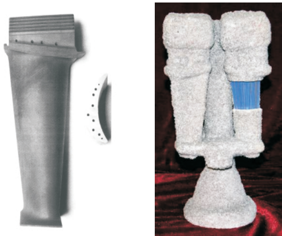
图2 左图为九孔空芯涡轮叶片,右图为空心叶片精密铸造模壳,蓝色部分为石英管
