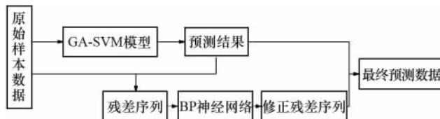
图 2 组合预测模型结构 Fig. 2 Structure of combination forecasting model
