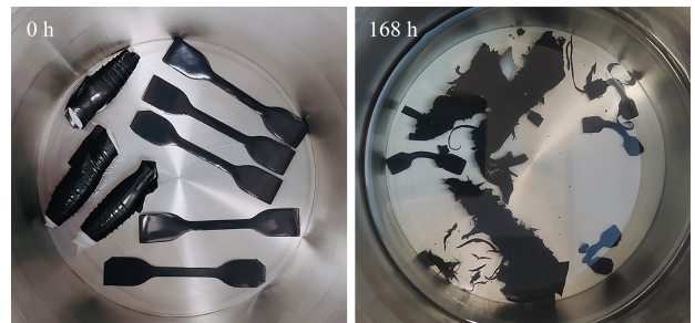
(a) 试验前 (b) 试验后 图10 卤化丁基+乙丙防水绝缘带在相容性试验前后的外观
