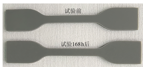
图 5 硅橡胶在相容性试验前后的外观变化
