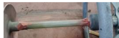
图17 CX-1发热绝缘子剖检图像
