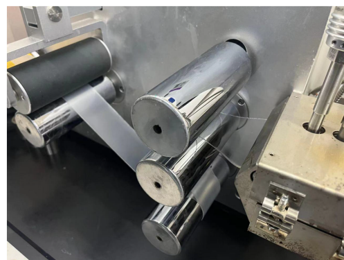
图1 PP-g-MAH的熔融挤出过程
