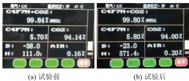
图7 环网柜绝缘试验前后气体混合比和微水含量的检测结果
