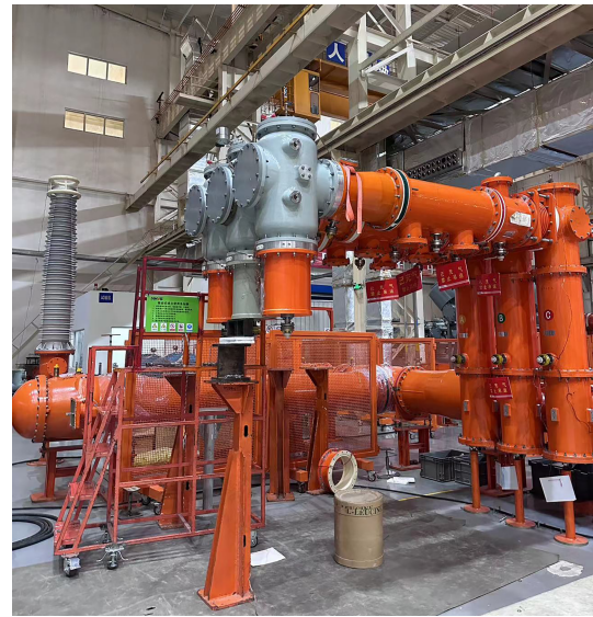
图 22 含地屏环的 252 kV 盆式绝缘子试验样机
