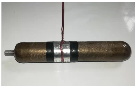
图2 主绝缘内部气隙缺陷模型实物图
