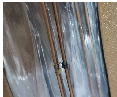
图4 雷电冲击试验后的匝间绝缘模型
