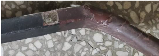
图3 端部半导体涂层及防晕层交叠部位故障试验模型
