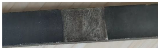
图2 槽内线圈磨损试验模型
