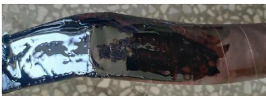
图4 表面污染试验模型
