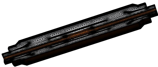
图2 电缆中间接头模型网格划分
