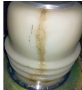
图 1 支柱绝缘子的沿面闪络现象
