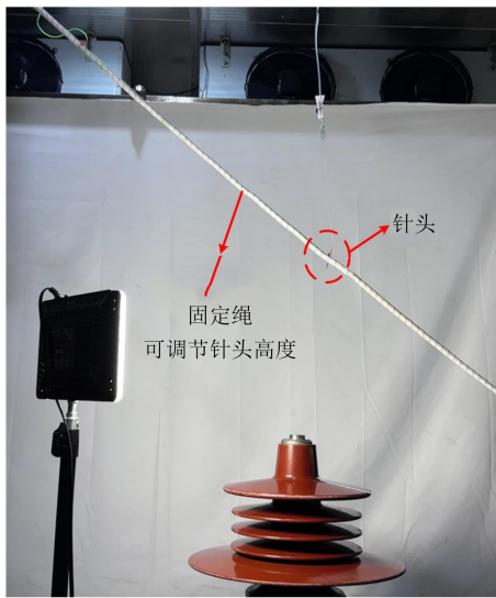
图6 试验场景布置示意图
