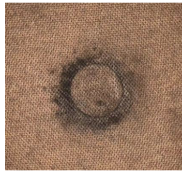
图6 沿面放电试验后绝缘纸板
