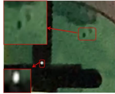
图5 试验过程中火花放电及气泡
