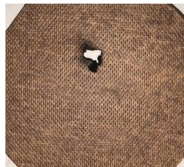
图7 金属突出物试验后绝缘纸板
