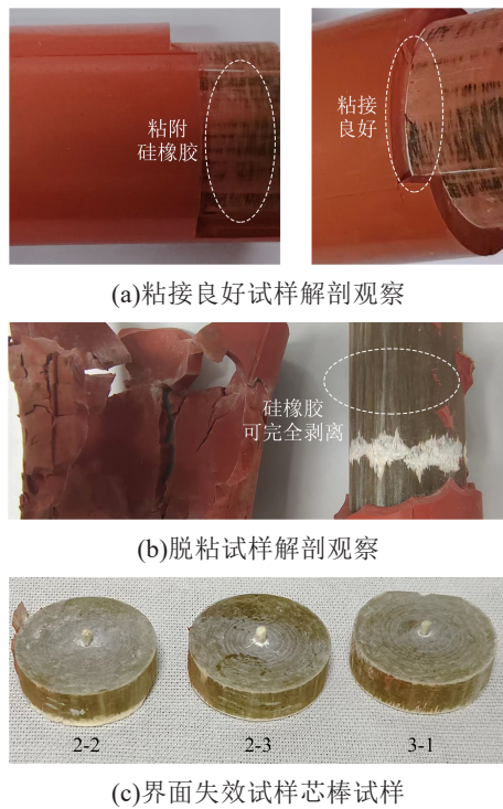
图8 解剖后的试样外观
