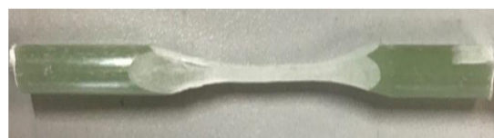
图13 力学性能试验样品
