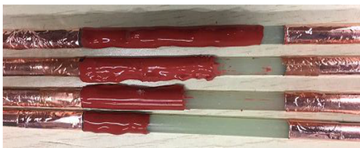
图10 人工模拟鸟啄护套损伤复合绝缘子样品
