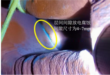
图2 层间间隙放电表面腐蚀图
