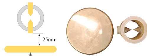
图 2 悬浮电极缺陷模型及实物图
