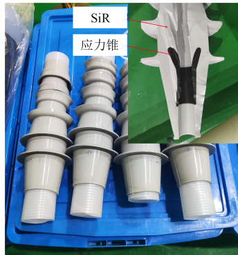
图 13 试验样品及剖面图
