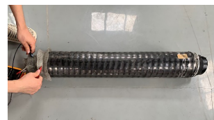
图15 电缆缓冲层接触电阻测量示意图
