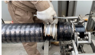
图8 连接孔攻丝过程示意图
