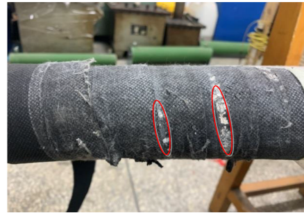
图2 110 kV高压XLPE电缆缓冲层白斑分布图
