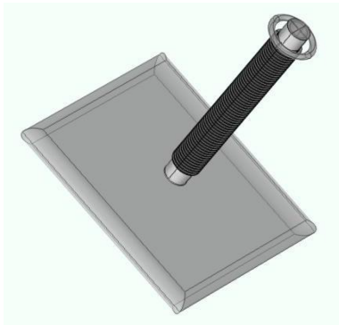
图9 缩比复合绝缘横担模型
