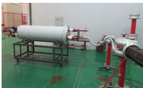
图2 中压EPA局部放电试验
