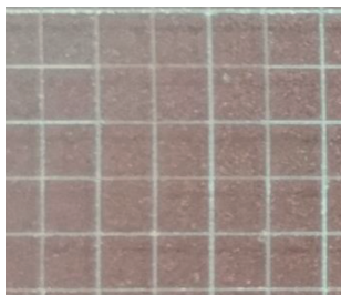
图3 超疏水涂层的附着力测试结果
