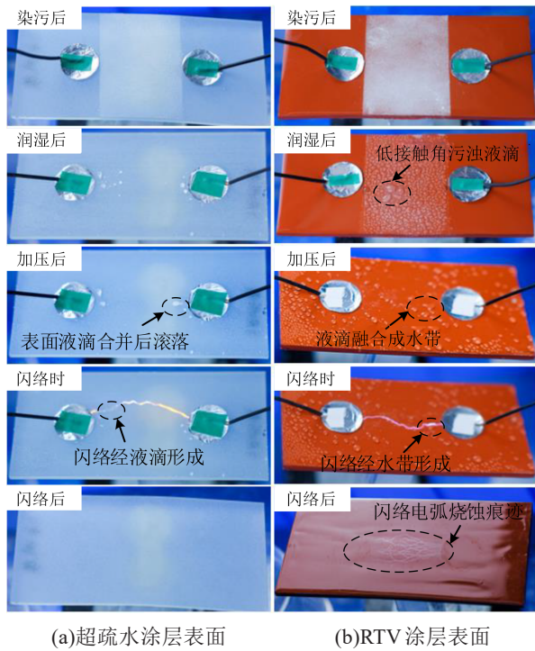
图 11 试品表面污秽闪络放电过程
