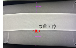
图 9 某 220 kV 高压电缆熔接头 DR 成像
