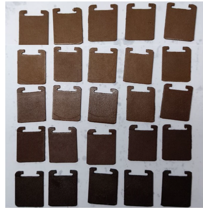
图4 加速老化后的绝缘垫块
