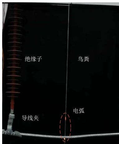
图12 裸导线下真型模拟试验
