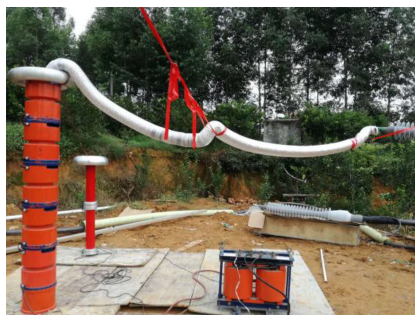
图5 XPLE 电力电缆介损试验
