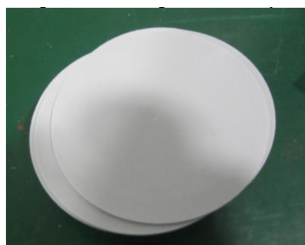
图4 机加工所得喷口材料试样
