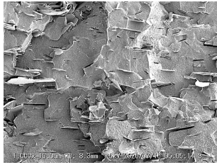
图7 单填料复合材料断面形貌图
