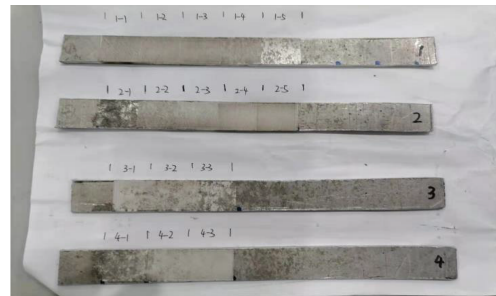
图11 经过多次激光清洗的铝条粗糙度对比
