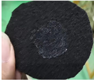
图5 缓冲层电化学腐蚀产生白斑
