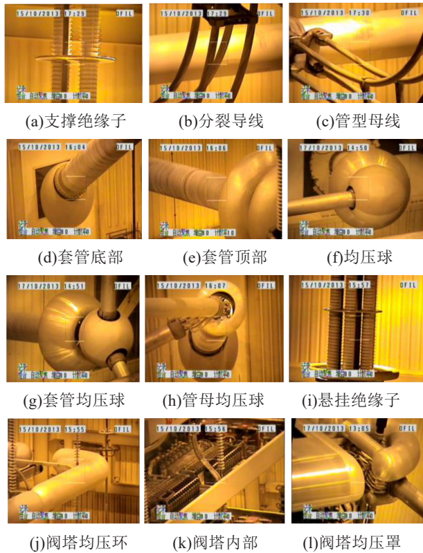
图6 电力设备紫外成像仪观测结果
