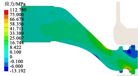
图13 绑定接触下绝缘子应力分布
