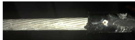
图10 导体裸露处绝缘导线表面烧蚀现象
