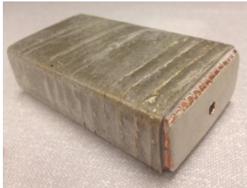
图2 试验采用的一小段电机定子线棒
