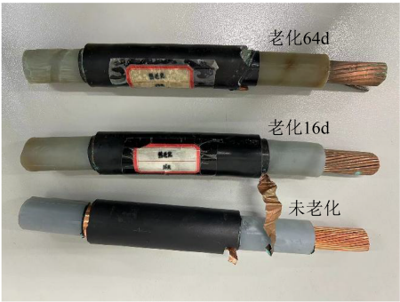
图5 不同老化时间的电缆试样 Fig.5 Cable samples with different ageing times
