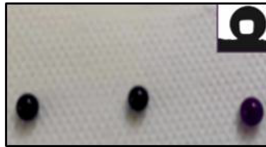
图 9 \text{RTV@Fn-SiO}_2(11)\#\text{Fm-SiO}_2 涂层的疏水性测试结果
