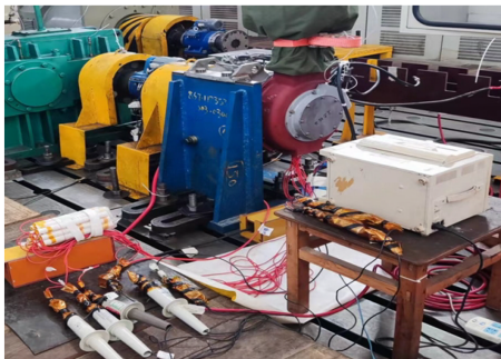
图8 电压应力测试平台
